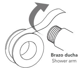
1. Proteja los extremos roscados del brazo ducha con cinta de teflón para evitar filtraciones.
