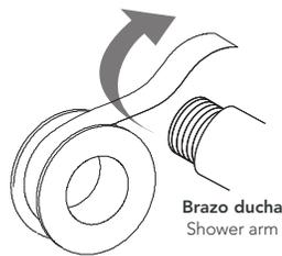
1. Proteja los extremos roscados del brazo ducha con cinta de teflón para evitar filtraciones.
