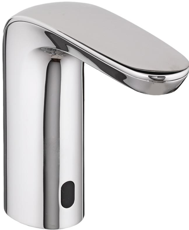
Activada por proximidad. Diseño oculto, sensor y válvula en el cuerpo de la llave. Rango de presión de agua de 20 a 120 psi. Montaje a una sola perforación anti vandálico. Una sola entrada para agua fría, templada o premezclada.
